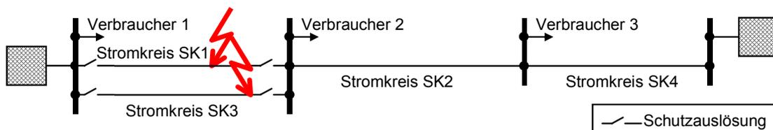
**Abbildung 2.6:** Common-Mode-Ausfall der Stromkreise SK1 und SK3
